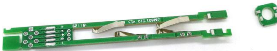
图 2.2 焊接弹片并给焊盘上锡
