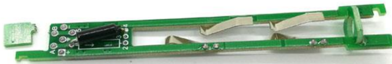
图 2.3 焊接震动开关及圆孔支架 PCB
