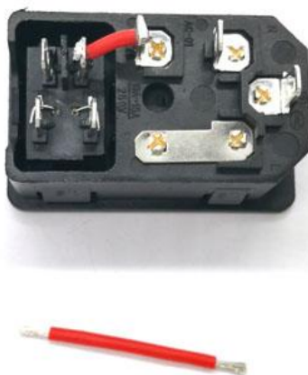
图 4.5 焊接短线至开关和插座相邻的两个引脚
