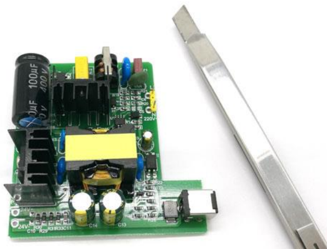
图 5.1 用美工刀去除电源板两边毛刺
