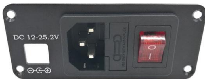
图 4.7 安装好的后面板总成
