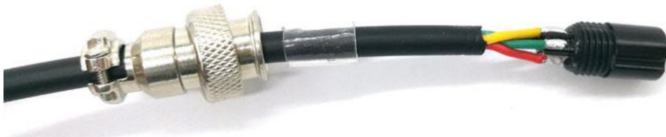
图 2.7 绿色线相邻的线焊接黄色线
