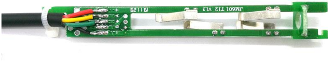
如图 2.4 焊接手柄线并用扎带扎住
