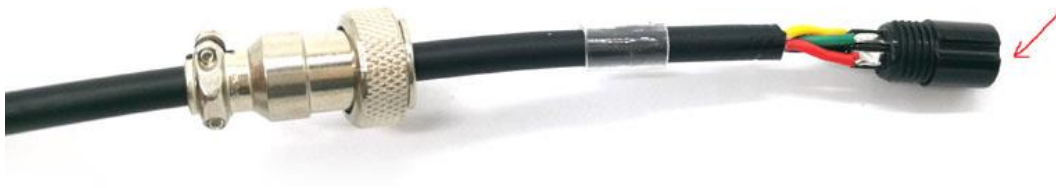
图 2.6 手柄线另一端焊接航空插头
