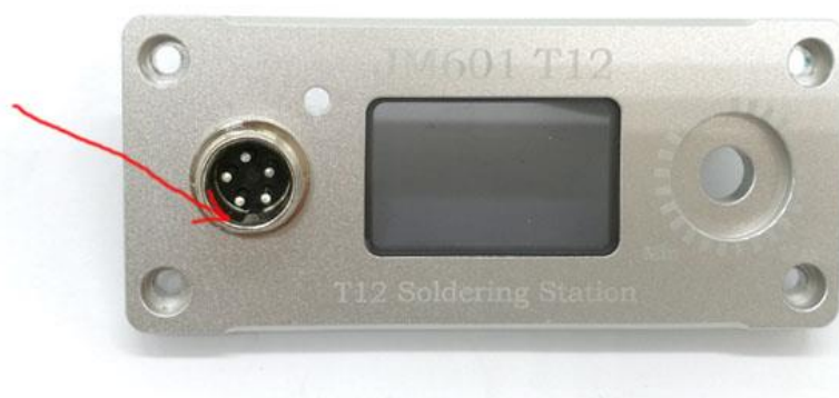
图 3.6 航空插头公头的凸起点朝下
