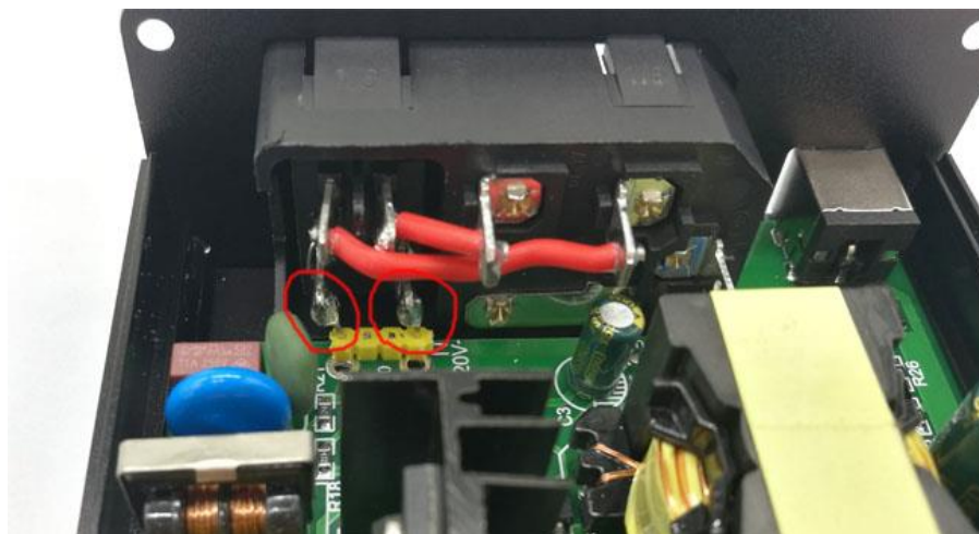
图 5.4 焊接开关与电源输入引脚
