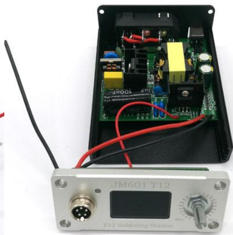
图 5.7 焊接面板上的 3 根线到电源板上
