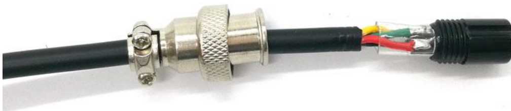
图 2.9 将绝缘套管移至焊点处
